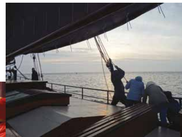
Backstagen umspannen bei jeder Wende oder Halse
